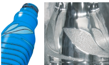
Blatt-Struktur (photochemisch geätzt)
